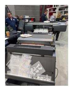
timierten Tintenverbrauch sowie einen energiesparenden Betrieb aus. Um die Wartung zu erleichtern, wurde der TY-300 mit einer automatischen Wartungsfunktion ausgestattet; je nach Nutzung erfolgt die Reinigung des Druckkopfs automatisch.
